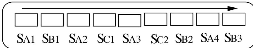
Figure 5 *Solution d'un processus d'usinage de la pièce {EA, EB, EC} (toutes les combinaisons de séquences sont possibles) :*
