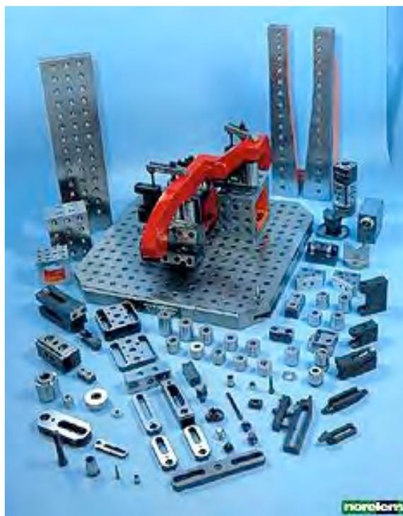
coûts. Dans le cas de productions répétitives, les montages d'usines sont systématiquement recomposés à chaque lancement de production. L'ensemble des composants est ainsi commun à plusieurs montages d'usinage. Le temps de recomposition d'un montage est d'environ 30mn, l'opérateur possède dans ce cas une liste des composants nécessaires et une photographie du montage à recomposer.
